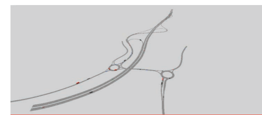
➔ Slika 18: Mikrosimulacijski model petlje Vogošća
