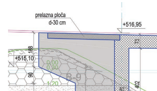
↓ Slika 25: Detalj dilatiranja prelazne ploče i krilnog zida
