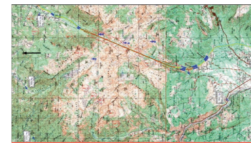
→ Figure 8: Mjesta upuštanja trasera i vrela monitoringa pri bojenju podzemnih vodnih veza trasa tunela
