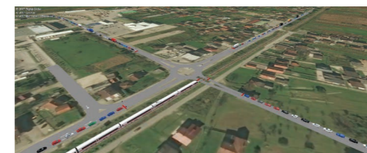
➔ Slika 19: Mikrosimulacijski model jednostranog kružnog toka sa pružnim prelazom
