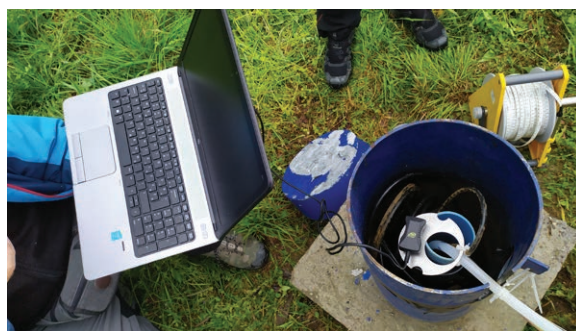
Slika 5. Preuzimanje podataka NPV-a sa logera iz piježometra OKP-1 u Orašju
